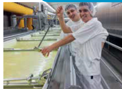
Teamwork am Koagulator: Moritz zieht eine Probe vom Bruch-Molke-Gemisch, Philipp kontrolliert die Bruchhärte.
